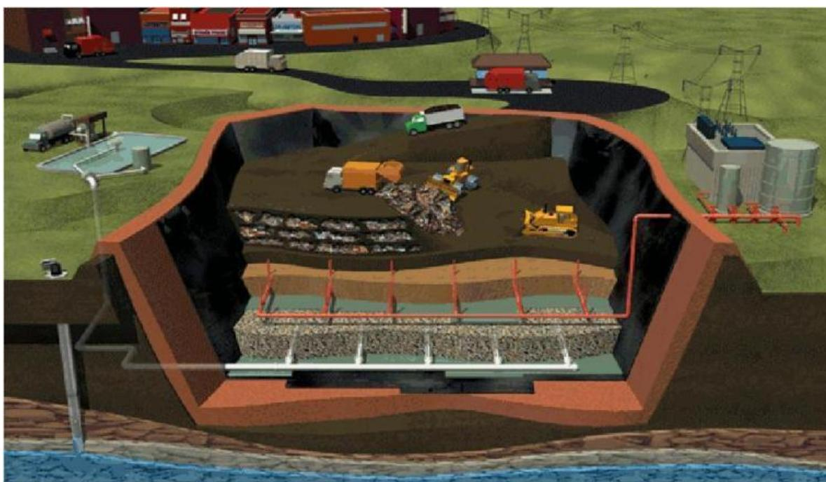
**Figura 5.** Modelo de Aterro Controlado
